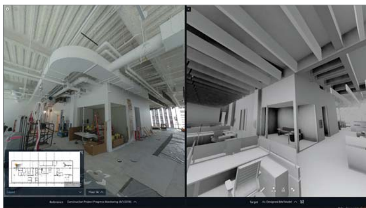
<그림 4> 예시: 큐픽스의 BIM compare (비교) 기능 - 실제 현장의 모습과 설계된 3D BIM 모델을 같은 시점 기준으로 비교
